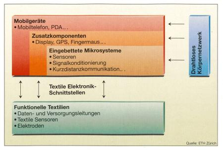
Bild 1 Integrationsebenen eines Wearable Computers
