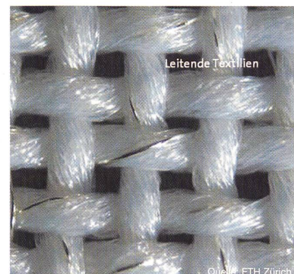
Bild 3 Gewobene Textilien mit leitenden Fasern
