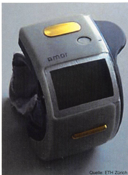
Bild 9 AMON: Überwachungs- und Alarmsystem am Handgelenk
