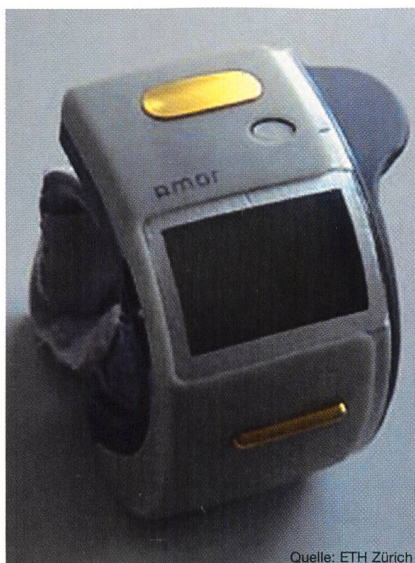
Bild 9 AMON: Überwachungs- und Alarmsystem am Handgelenk
