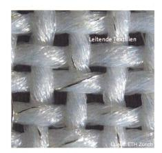
Bild 3 Gewobene Textilien mit leitenden Fasern
