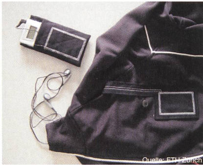
Bild 4 Gestickte Spule zur drahtlosen Kopplung zwischen MP3-Player und Kopfhörer
