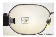
Bild 7 Microdisplay (von Microoptical Corp.)
