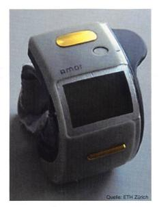
Bild 9 AMON: Überwachungs- und Alarmsystem am Handgelenk
