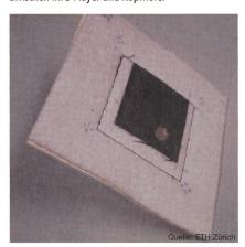
Bild 5 Textile Bluetooth-Antenne
