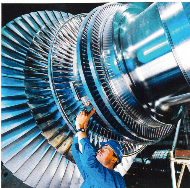
Wartung einer Kraftwerksanlage (Dampfturbinenrotor/Bild Siemens).
