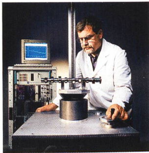
Der Verschleiss von Maschinenteilen kann durch den Abrieb radioaktiv markierter Oberflächen sehr präzise untersucht werden. Das Bild zeigt ein am Zyklotron bestrahltes Bauteil bei der Qualitätskontrolle (Foto Forschungszentrum Karlsruhe).
