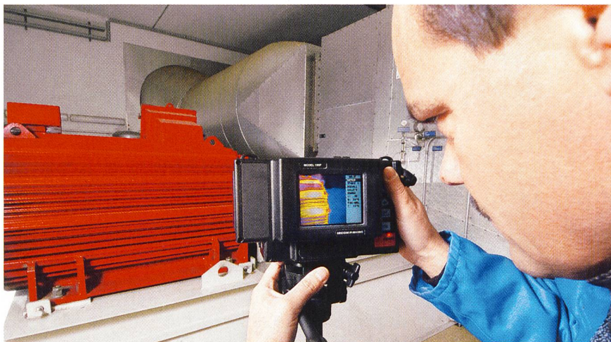
Vorbeugende Instandhaltung: Lager-Diagnose an elektrischem Antrieb.
