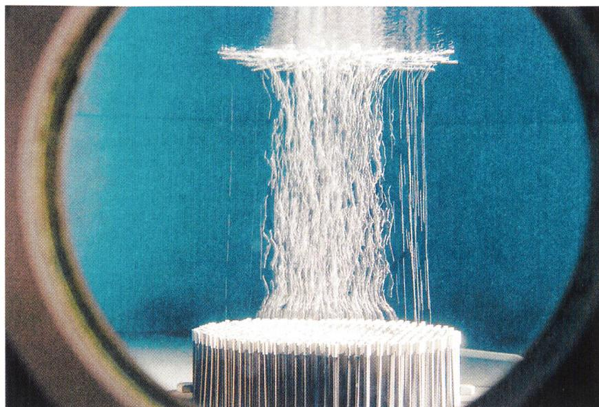
Blasenschwarm: Kleine Luftblasen werden durch Kapillarrohre in einen grossen Wasserpool gespeist. Kurz unterhalb der Wasseroberfläche werden die Blasen durch die Wasserströmung teilweise radial nach aussen gezogen (Bilder PSI).
