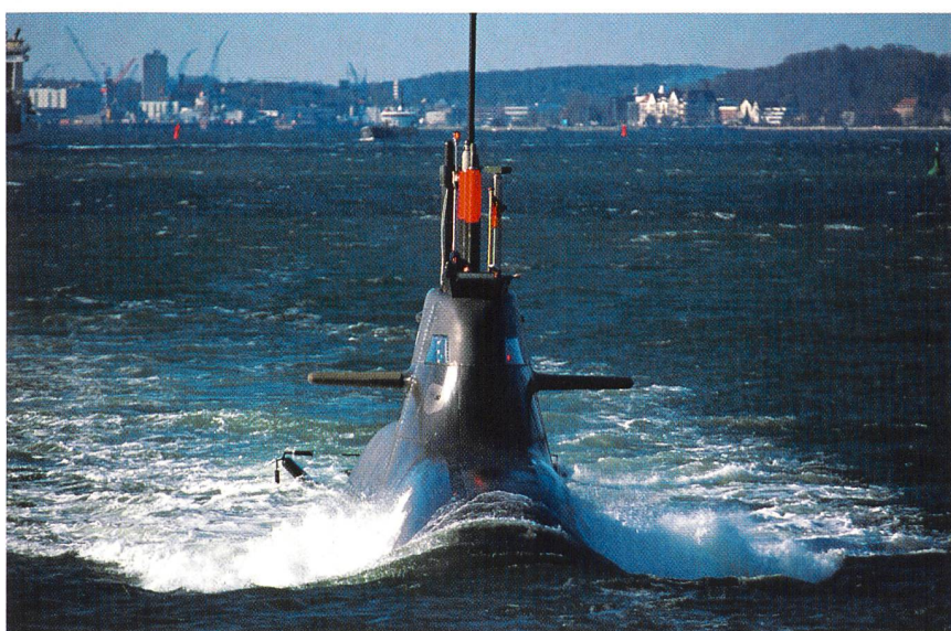
Erstes serienreifes U-Boot («U 31», Klasse 212) mit aussenluftunabhängigem Brennstoffzellen-Antrieb (Bild HDW).
