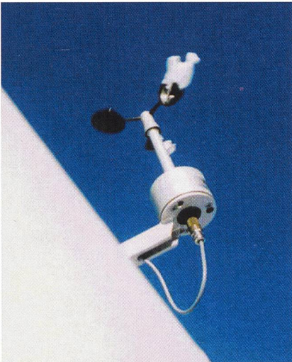
Bild 5 Auch an diesem Anemometer an der Anlage auf dem Titsli setzte sich Raureif an – trotz geheiztem Instrument. (Foto ADEV).
