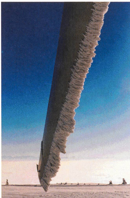
Bild 2 Reifbildung an einem Rotorblatt der Grenchenberg-Anlage, nach einer Woche Nebel am Standort (Foto ADEV).
