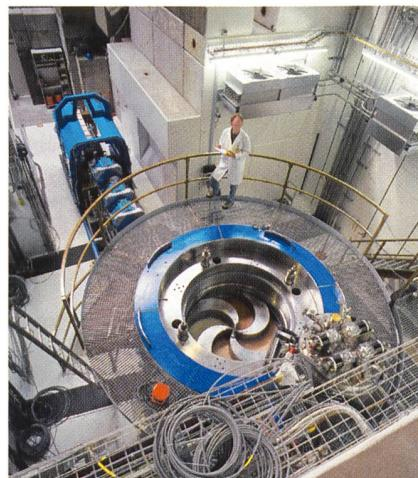
**Titelbild:** Zyklotron beim PSI, in dessen Innern vom Zentrum aus Protonen beschleunigt werden. Dazu ist ein sehr starkes Magnetfeld notwendig. Dieses wird mit supraleitenden Spulen erzeugt, die den Strom widerstandslos und verlustfrei leiten. Am Boden montiert sind weitere Magnete (blau), mit denen die Protonen zur Bestrahlungseinrichtung gelenkt werden (Foto: H.R. Bramaz/PSI).
