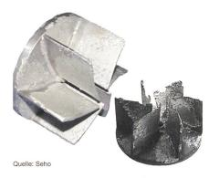
Bild 2 Aggressive bleifreie Lote Unbeschichtete Pumpenräder nach dem Einsatz mit bleifreiem Lot
