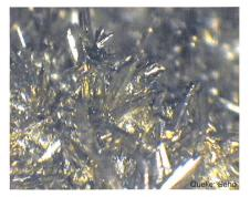
Bild 3 Durch FeSn2-Intermetalle geformte Nadeln im Lotbad
