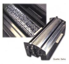
Bild 1 Turbulente Lötwelle
