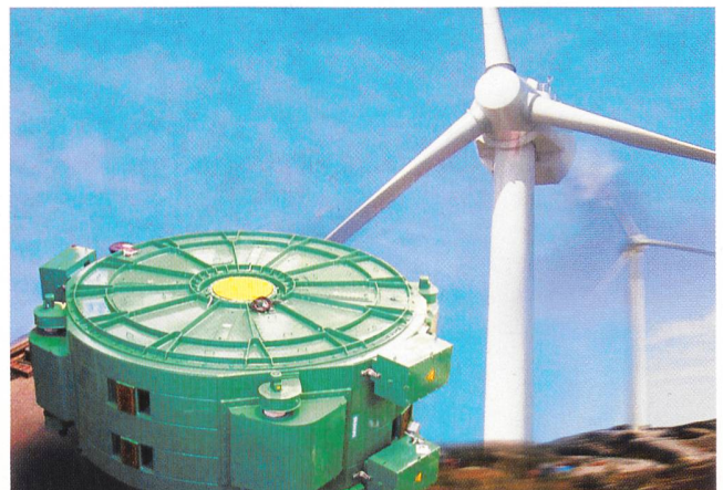
Windkraftanlage mit Permanentmagnet (Bild Siemens).
