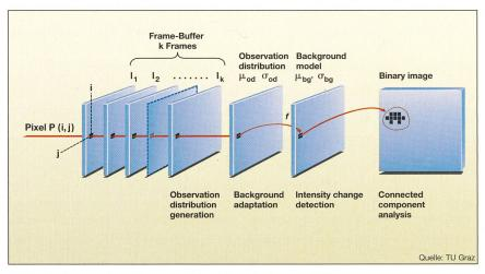
Bild 2 Verarbeitungsschritte der automatischen Stillstandserkennung (ASE)
