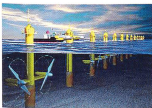
Unterwasserkraftwerk «Seaflo» (Bild VA Tech Elin).
