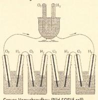
Groves Versuchsaufbau (Bild SCIFI/f-cell).
