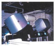
Verwendet wurden Flugsimulatoren der MaxFlight Corporation, die jeweils für zwei Personen Platz bieten. Während eine Person als Pilot agiert, bedient die andere die Abschussvorrichtungen. Die Rollen können per Knopfdruck vertauscht werden. In Ahaus stehen gesamthaft vier Simulatoren zur Verfügung, die für interaktive Spiele vernetzt sind. (Bild: MaxFlight Corporation)
