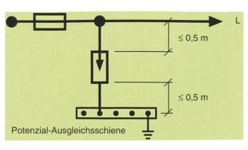
Bild 1 Vorgeschriebene Leitungslängen bei der Installation von Überspannungsschutzeinrichtungen gemäss der Norm VDE 0185 Teil 4
