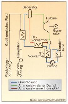
Bild 5 Blockschaltbild des Kalina-Prozesses HT: Hochtemperatur; NT: Niedertemperatur
