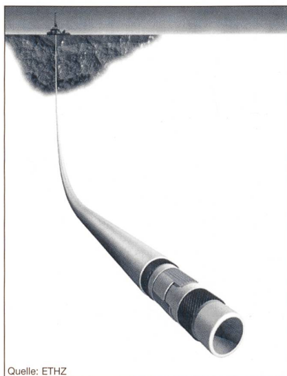
Bild 2 Schematische Darstellung des «Power and Data Transmitting Composite Coiled Tubing»
