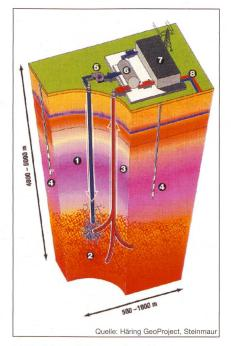
Bild 3 Schematische Darstellung des «Hot Dry Rock»-Verfahrens
