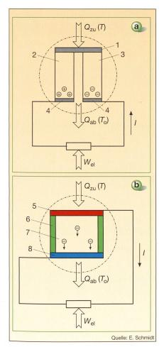
Bild 8 Schematischer Aufbau des sekundären Energiewandlers
