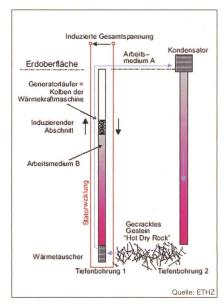
Bild 6 Einbezug eines linear wandelnden Generators in ein «Hot Dry Rock»-Schema
