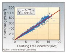
Bild 8 Leistungscharakteristik des Solargenerators
