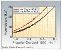
Bild 7 Leistungscharakteristik vor und nach Propeller-Reparatur
