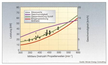
Bild 5 Leistungscharakteristik des MobiCat
