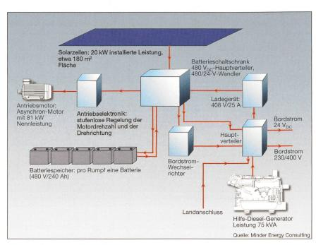
Bild 2 Blockschema der elektrotechnischen Baugruppen
