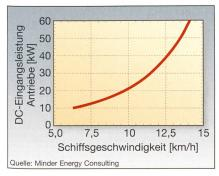
Bild 6 Leistungsbedarf der Antriebe in Funktion der Schiffsgeschwindigkeit
