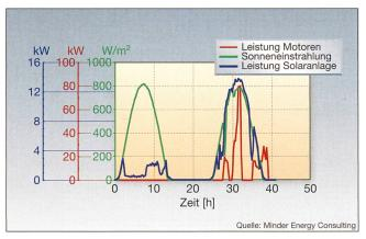
Bild 11 Vergleich zweier Tageskurven ohne und mit Schiffsbetrieb
