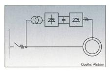
Bild 7 Doppelt gespeiste Asynchronmaschine mit Spannungsumrichter im Rotorkreis
