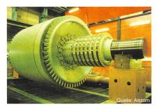
Bild 8 3-Phasen-Asynchronrotor der Anlage Seebach mit einer Leistung von 62 MVA
