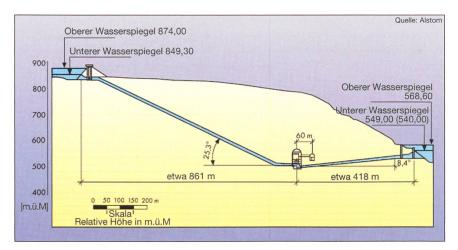
Bild 9 Ober- und Unterbecken der Anlage Goldisthal mit einer Höhendifferenz von 300 Metern
