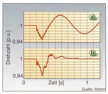
Bild 2 Drehzahl während Spannungseinbruch bei konventioneller Lösung (a) und Varspeed-Lösung (b)
