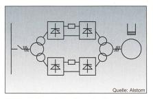
Bild 5 12-pulsiger lastgeführter Umrichter
