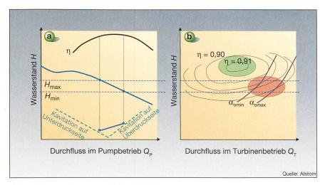
Bild 1 Wirkungsgrad in Pump- und Turbinenbetrieb
