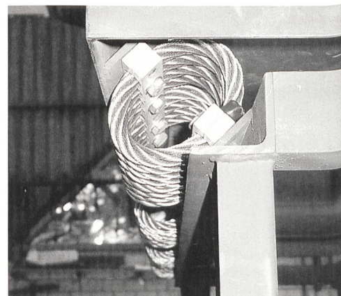
Bild 5 Bodenrahmen mit Drahtseilfeder-Elementen.
