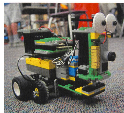
Ein visueller Chip ermöglicht es dem Roboter, ein sich bewegendes Objekt zu erkennen und zu verfolgen (Bild: CH-Forschung: Institut für Neuroinformatik, Universität Zürich)
