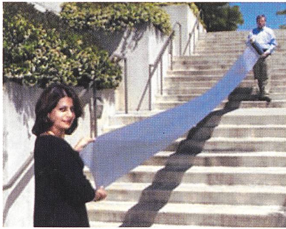
Elektronisches Papier lässt sich in beliebiger Länge produzieren (Quelle: Gyricon)
