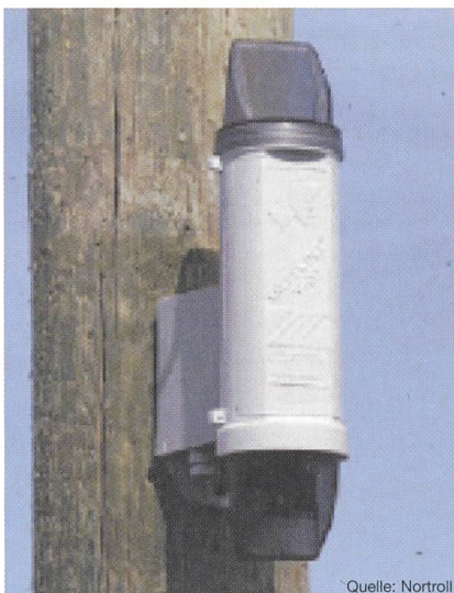
Bild 5 Fehlerstromanzeiger vom Typ Linetroll 3500 Dieser Fehlerstromanzeiger wird unterhalb der Leiter auf der Holzstange bzw. dem Betonmast montiert und kann zwischen Last-, Kurzschluss- und Erdschlussströmen gerichtet unterscheiden.
