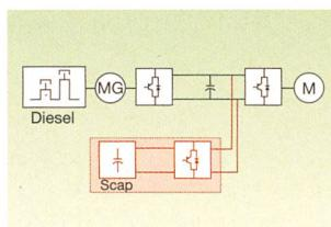
**SUPERCONDENSATEURS****Utilisation du stockage supercapacitif dans le domaine traction**
