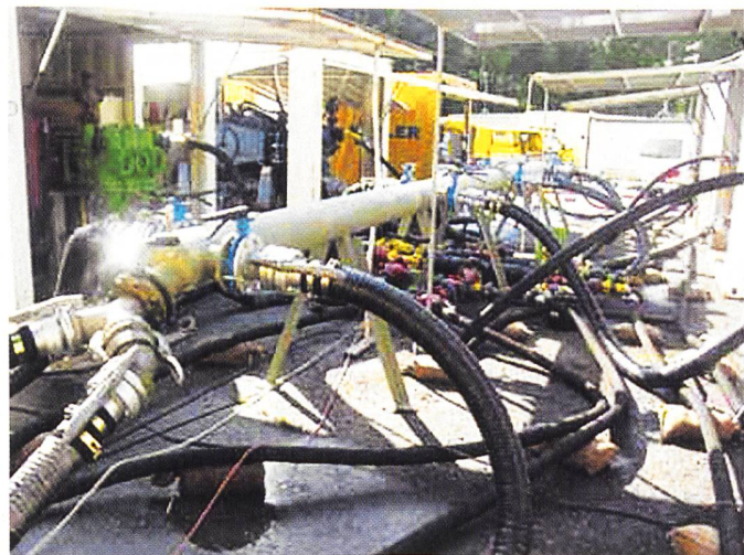
Aufbau der Pumpen für den hydraulischen Stimulationstest in der Urach 3.
