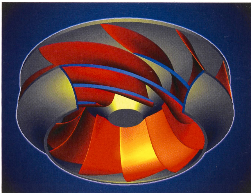
Für die polnische Anlage Zarnowiec entwickelte VA Tech Hydro ein neues Laufrad, das eine Wirkungsgradsteigerung und den reibungslosen Betrieb bei Turbinenteillast ermöglicht.
