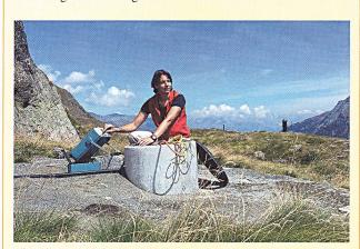
Alle Bohrungen sind mit verschiedenen Messgeräten ausgestattet: Inklinometer messen die durch Verschiebungen der Gesteinsmasse verursachten Neigungsänderungen der Bohrungen, Extensometer messen Längenänderungen der Bohrungen, Geophone zeichnen winzigste Erschütterungen in der Tiefe auf, Piezometer bestimmen den Druck des in der Tiefe vorhandenen Wassers (Bild snf).
