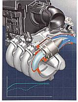
Die elektrische Impulsaufladung bringt mehr Luft in den Zylinder und erhöht so den Drehmoment (Bild Siemens VDO Automotive).
