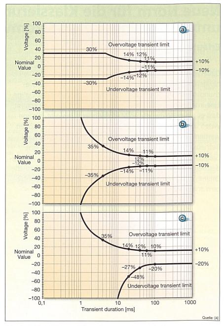
Bild 1 Dynamische Toleranzkurven des Ausgangs
