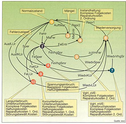
Bild 5 Zustandsdiagramm für die LCC-Berechnung der Beispielkomponente
