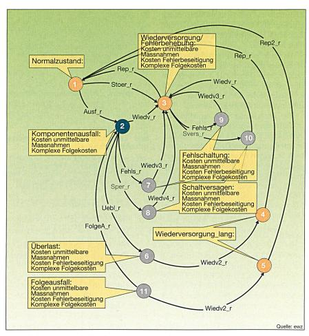
Bild 8 Zustandsdiagramm für Einfachausfälle von Komponenten im Unterwerk
