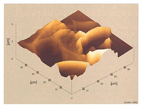
Bild 2 Oberfläche einer Polymerfolie Aufnahme mittels Rasterkraftmikroskopie
