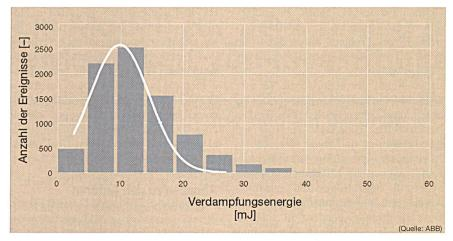
Bild 4 Statistische Verteilung der zur Verdampfung einer Elektrode erforderlichen Energie  $\mu$  = 9,6 mJ;  $\sigma$  = 6,9 mJ;  $\sigma$  = 12,2 mJ
