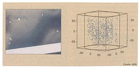
Bild 5 Teil einer metallisierten Elektrode mit Durchschlagsstellen (links) aus einem beschleunigt gealterten Kondensator und 3-D-Darstellung der Durchschlagsstellen in einem Kondensatorelement
