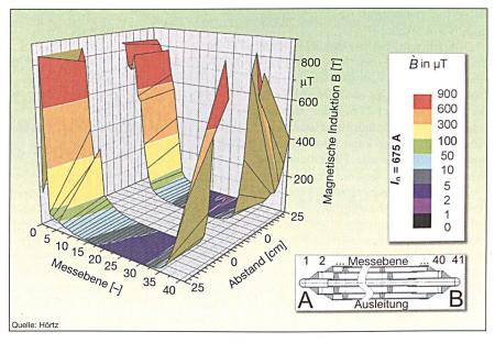
Bild 7 Gemessene magnetische Induktion B der Messebene 0 bis 41 von Konfiguration II (jeweils auf Phasenleiter  $L_3$  und in 25 cm Abstand)
