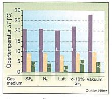
Bild 6 Gemessene Übertemperaturen des Kogil nach 12 Stunden Belastung
