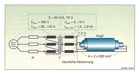
Bild 5 Prinzipschaltbild des Hochstromversuchsstandes zur Temperatur- und Magnetfeldmessung S = 60 kVA, YD 5; Primärseite des Transformators:  $U_{\text{prim}} = 380 \text{ V}$ ;  $I_{\text{prim}} = 99-135 \text{ A}$ ; Sekundärseite des Transformators:  $U_{\text{sek}} = 9-19 \text{ V}$ ;  $I_{\text{sek,max}} = 1,8-2,9 \text{ kA}$
