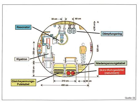
Bild 1 Tunnelquerschnitt des geplanten Linearbeschleunigers Tesla
