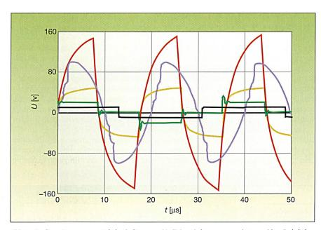
Bild 6 Simulierte Spannung am Kabelende für unterschiedliche Taktfrequenzen und Innenwiderstände bei einer Eingangsspannung von ± 10 V
