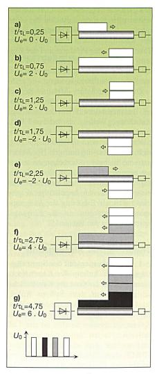
Bild 1 Entstehung kritischer Überspannungen am Kabelende auf Grund von Multiplen Reflektionen
