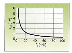
Bild 2 Kritische Kabellänge als Funktion der Taktfrequenz
