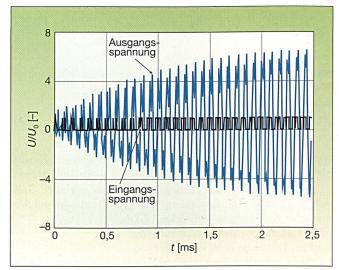
Bild 9 Spannungsverlauf am offenen Kabelende (Ausgangsspannung) bei Speisung mit einer nach dem Pulsweitenverfahren modulierten Eingangsspannung Ausschnittsvergrösserung aus Bild 8
