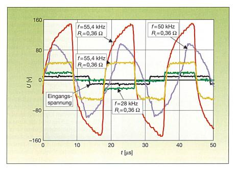
Bild 5 Gemessene Spannung am Kabelende für unterschiedliche Taktfrequenzen und Innenwiderstände bei einer Eingangsspannung von ±10 V
