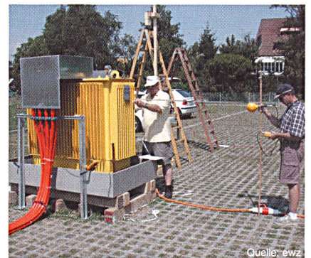
Bild 3 MS/NS-Transformator mit Anschluss-Abschirmhaube über dem NS-Kabelanschluss Das magnetische Feld wird von den ESTI-Prüfern ausgemessen
