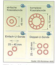
Bild 3 Konstruktionsprinzipien von Erdwärmesonden
