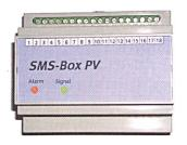
Die SMS-Box überwacht Fotovoltaikanlagen
