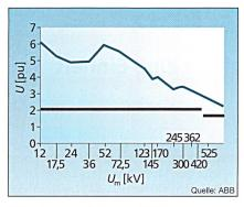
Bild 3 Unterer Isolationspegel (BIL)
