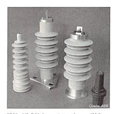
Bild 7 Möglichkeiten zur Integration von Ableitern Der 24-kV-Ableiter (zweiter von links) und die Freiluftdurchführung (links) sind in einer kompakten Ableiter-Durchführung integriert worden (zweiter von rechts), welcher steckbar mit dem genormten Steckanschluss (rechts) verbunden werden kann.
