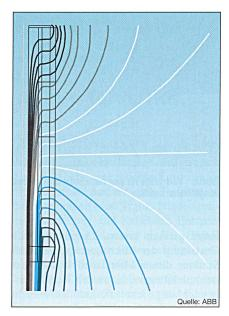
Bild 8 Elektrische Feldverteilung für den hochintegrierten 24-kV-Ableiter-Kabelendverschluss
