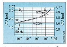
Bild 2 Schutzcharakteristik eines modernen Überspannungsableiters für die Verteilungsebene
