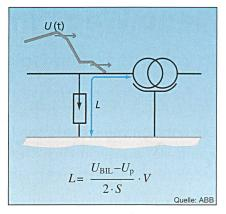
Bild 4 Wechselwirkung eines Überspannungsableiters mit einer einlaufenden Wanderwelle *U*(*t*)
