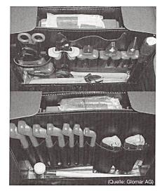
Bild 3 Werkzeug für das Arbeiten an unter Spannung stehenden Anlagen
