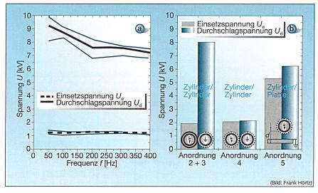
Bild 3 Einsetz- und Durchschlagspannung der verschiedenen Anordnungen
