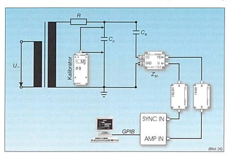
Bild 1 Schematische Darstellung des verwendeten Teilentladungsmesskreises
