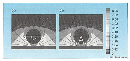
Bild 7 Simulation der elektrischen Feldstärke bei einer Spannungsbeanspruchung mit  $U_{\Delta}$  = 208 V, Maximalfeld 8,2 kV/cm
