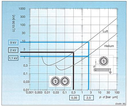
Bild 4 Durchschlagspannung in Abhängigkeit der Paschenkurve für Luft und Helium Schwarze Linie: Anordnung 4 gemäss Tabelle; blaue Linie: Anordnung 5 gemäss Tabelle.
