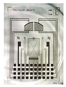
Bild 2 Glas-Sensorchip für mikrophysiologische Studien an zellulären Präparaten bei gleichzeitiger Lichtmikroskopie
