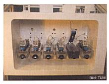
Bild 5 Frontalansicht eines 6-Kanal-Mikrophysiometers
