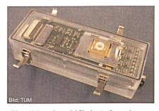
Bild 3 Elektronik-Modul für das Auslesen eines multiparametrischen Silizium-Sensorchips
