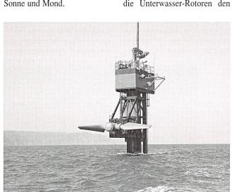
Der zweiflüglige Rotor misst 11 Meter im Durchmesser und dreht sich 15 Mal in der Minute (Rotor bei Montage).
