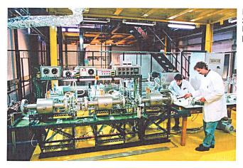
Mikrowellenapparatur zur Erzeugung und Beschichtung von Nanopartikeln.
