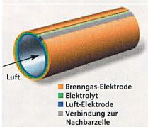
Funktionsprinzip der PEM- und der Festoxid-Brennstoffzelle. In Brennstoffzellen läuft eine im Prinzip explosive Reaktion sehr sanft ab: Die Verbindung von Wasserstoff und Sauerstoff zu Wasser – kontrol-
