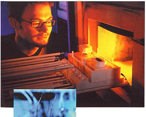
Siemens-Forscher in Erlangen testen bei hohen Temperaturen die elektrischen Eigenschaften neuer Festoxid-Brennstoffzellen; Detailansicht (unten). Bilder Siemens.
