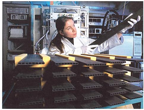
Eine Siemens-Entwicklerin überprüft die neuen extrem flachen Festoxid-Brennstoffzellen.
