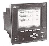
PML-Netzanalysator ION 7600 von Herren
