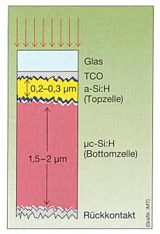
Bild 1 Aufbau einer micromorphen Dünnschichtzelle
