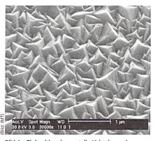
Bild 4 Zinkoxid verbessert die Lichtabsorption Zinkoxid hat in der Dünnschichtzelle des IMT zwei Funktionen: Einerseits leitet es auf der Vorder- und Hinterseite der Siliziumzellen den Strom ab, und an-
