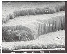
Bild 2 Mikroskopaufnahme der am IMT entwickelten micromorphen Dünnschichtzelle
