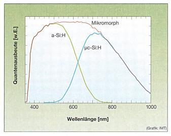
Bild 3 Höhere Lichtausbeute der micromorphen Zelle
