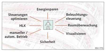
Bild 1 Die Information über die Raumbelegung wird zur zentralen Steuergrösse im modernen Gebäude.
