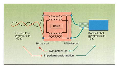
Bild 2 Schema für Balanced Unbalanced Signal Transformation (Balun)
