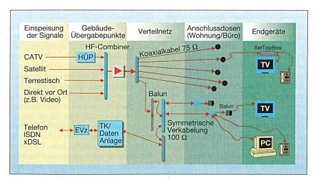
**Bild 1** Netzebenen zwischen Signaleingang und Endgerät
