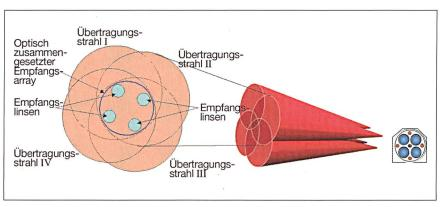
Bild 3 Divergierende Laser eines Mehrstrahlgerätes mit Projektionsfläche
