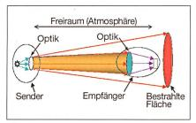
Bild 2 Schema eines optischen Freiraumübertragungssystems
