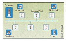
Bild 2 Typischer Aufbau eines PWLAN-Knotens
