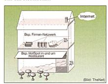
Bild 4 Typische Installation eines PWLAN-Hotspots AP: Access Point
