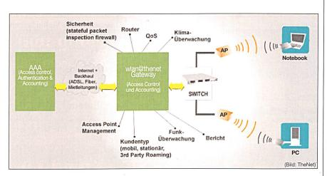
Bild 7 Schematische Darstellung eines PWLAN-Knotens
