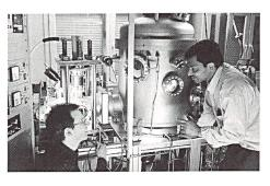
In der Edelgaskondensationsanlage im Institut für Nanotechnologie des Forschungszentrums Karlsruhe werden nanostrukturierte Partikel, beispielsweise aus Platin, hergestellt. 4 4
