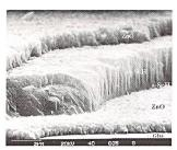
Mikromorphe Solarzellen sind eines der Beispiele für die erfolgreiche Umsetzung Schweizerischer Forschungsarbeiten (Bild: IMT)
