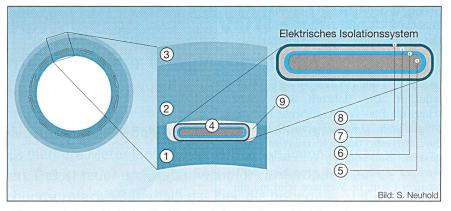
Bild 3 Querschnitt des künftigen Bohrschlauches mit den eingelegten elektrischen Leitern
