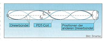
Bild 6 Anordnungen der Glasfasern des verteilten optischen Messsystems
