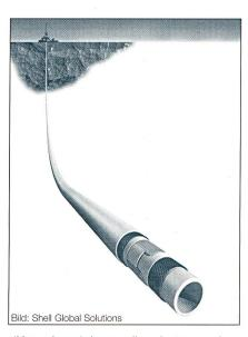
Bild 2 Schematische Darstellung des Power and Data Transmitting Composite Coiled Tubing
