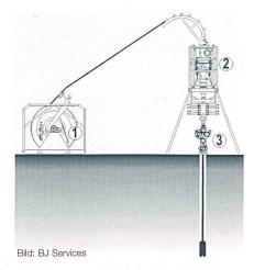
Bild 1 Schematische Darstellung des Steel Coiled Tubing
